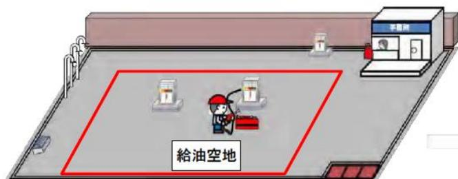
(固定給油設備から容器への詰替えのイメージ (給油空地内で実施))
